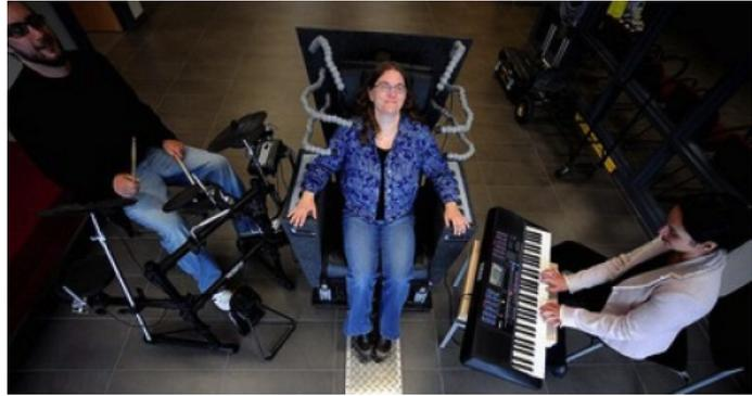
Beim Emoti-Chair handelt es sich um einen «Sessel» der im Innern aus verschiedenen Technologien besteht. Grundsätzlich sind verschieden Vibratoren in den Sessel eingebaut, die über ein Mehrkanal Input gespeist werden. Somit lassen sich verschiedenen Instrumente, Klänge, Rhythmen der Musik in verschieden starke Vibrationen an den Sessel übermitteln. Im Rückenbereich werden z.B. Bässe und Rhythmen vermittelt, in den Armlehnen die Stimmen und Klänge usw.
